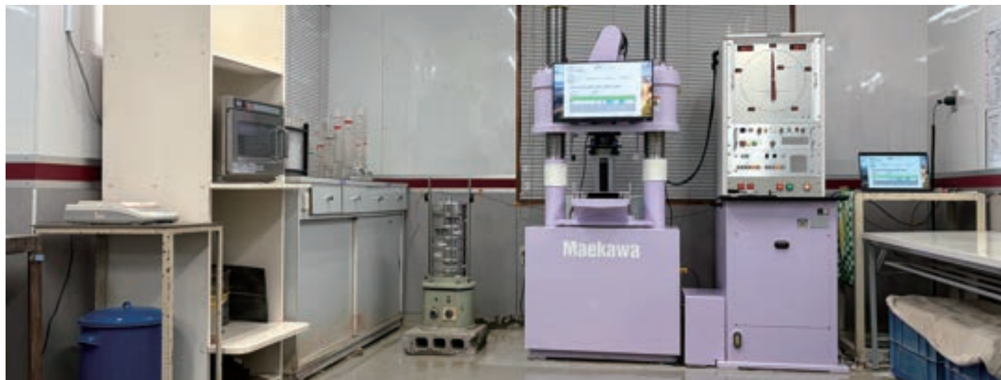
アムスラー式耐圧試験機 2000KN スランプ及びスランプフロー試験機 空気量試験器、骨材試験器 一式 単位水量測定器 一式、その他
